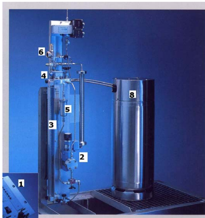
Slika 2. Uređaj za odoriranje
